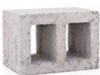
вентиляционный блок 36 x 25 см, h = 24 см, 12,5 кг, 11 x 16 см
